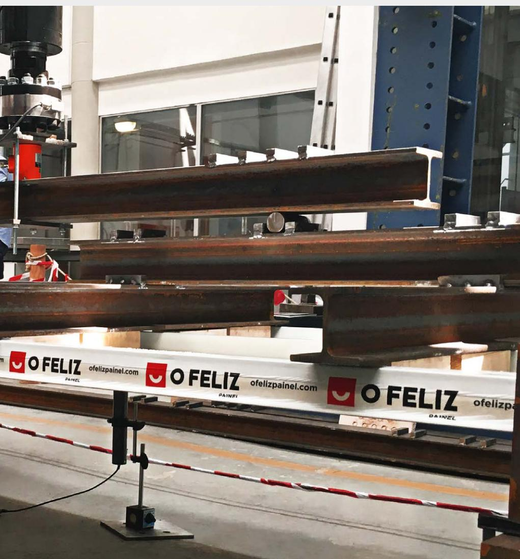
Neste caso a situação mais desfavorável dos esforços atuantes será a ação do vento de 1,30 kN/m<sup>2</sup>. Consultando os valores da tabela para um vão de cálculo de 2,75 m e para cargas ascendentes, verifica-se que para resistir a essa carga deverá ser dimensionado um painel Topcover 5 com faces de 0,5/0,4 mm e espessura de 50 mm.
